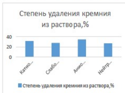
Рисунок 1 - Степени удаления (степени флокуляции) кремния на различных флокулянтах
